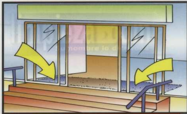
4 ES IMPORTANTE QUE LA ENTRADA A LUGARES ENMOQUETADOS ESTÉN PROTEGIDOS CON ALFOMBRAS ADECUADAS
