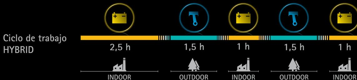
Gracias al sistema de alimentación combinada Hybrid se puede utilizar FSR tanto en el exterior como en el interior, escogiendo la alimentación de gasolina para los espacios externos y privilegiando el bajo nivel de ruido y la ausencia de emisiones del motor eléctrico en los espacios internos.
